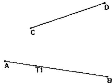
$T_1$  ist ein "Punkt auf Objekt" und kann auf der Strecke AB bewegt werden. Dieser Punkt ist unser Teilungspunkt für die Konstruktion der Bézier-Kurve.
