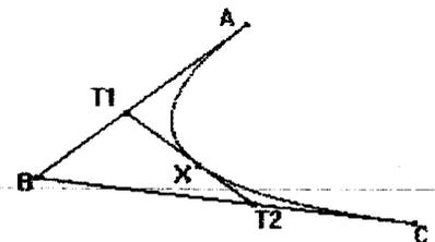
Anschließend kann man die Kurve als Ortslinie in CABRI konstruieren (X abhängig von  $T_1$ ). Durch Bewegen der Bézier-Punkte kann die Form der Bézier-Kurve geändert werden.
