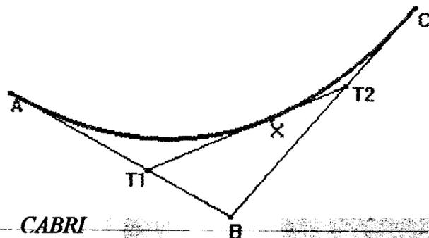
Die Variable  $t$  ist der **Parameter**. Für jedes  $t \in [0;1]$  ergibt sich ein Punkt der Bézier-Kurve, mit  $t = 0$  der Punkt A, mit  $t = 1$  der Punkt C. Wenn  $t$  die Zahlen im Intervall  $[0;1]$  durchläuft, so erhält man die gesamte Bézier-Kurve. Wenn sich  $t$  von 0 nach 1 verändert, so bewegt sich X auf der Kurve von A nach C.
