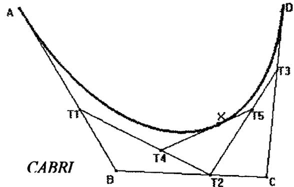
$$\overline{AT_1} : \overline{AB} = \overline{BT_2} : \overline{BC} = \overline{CT_3} : \overline{CD} = \overline{T_1T_4} : \overline{T_1T_2} = \overline{T_2T_5} : \overline{T_2T_3} = \overline{T_4X} : \overline{T_4T_5} = t : 1$$
