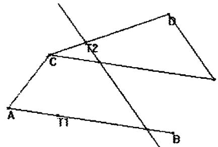
Diese Konstruktion ist der Grundbaustein für die Bildung der Bézier-Kurve. Sie wird als Makro gespeichert. Das Makro kann ausgeführt werden, wenn zwei Strecken (AB und CD) sowie ein Punkt ( $T_1$ ) auf einer der Strecken gegeben sind.
